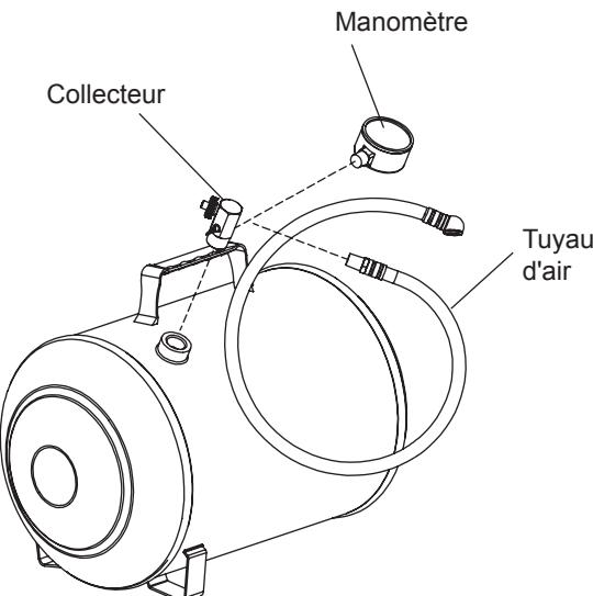
Figure 2 : Pièces de rechange d'un réservoir d'air
