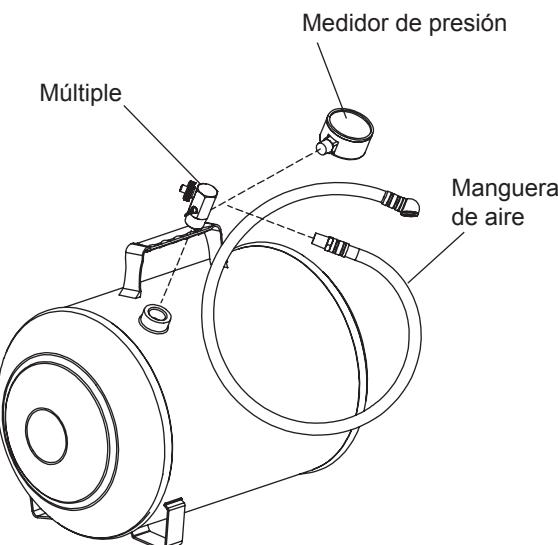
Figura 2: Piezas de repuesto de un tanque de aire
