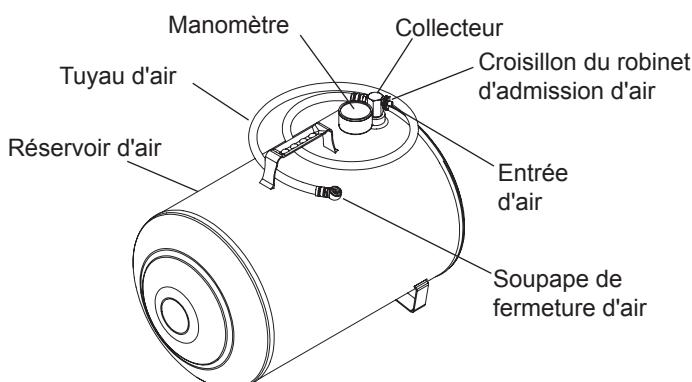
Figure 1 : Pièces d'un réservoir d'air typique
